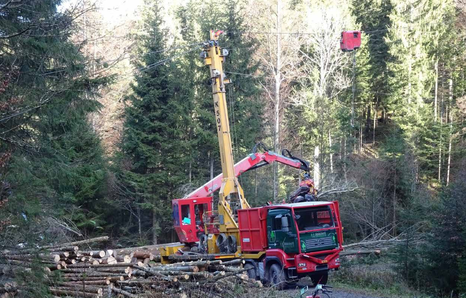
Seilbringung mit einem Koller K 507 Gebirgscharvester
