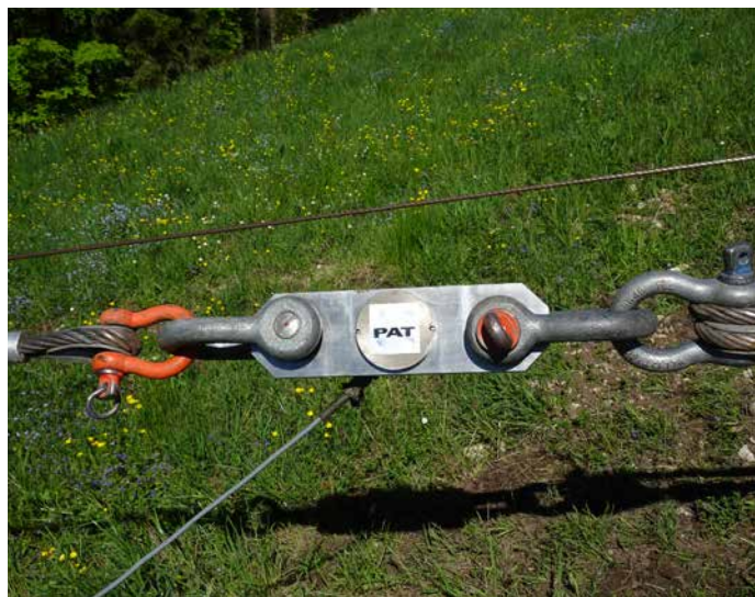
Abbildung 3: Ins Tragseil eingebaute Kraftmessdose zur Messung der Tragseilzugkräfte
